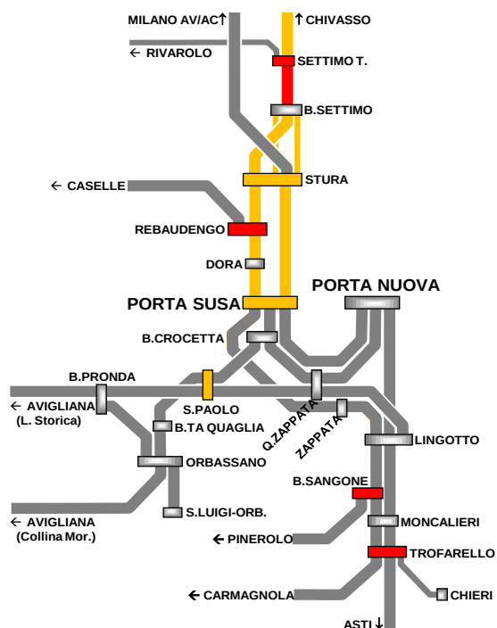
Utilizzazione simulata del nodo ferroviario di Torino In rosso le situazioni critiche, in giallo le situazioni di circolazione intensa
